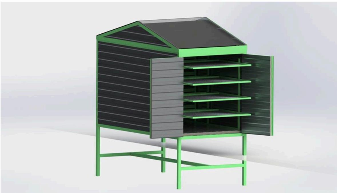
**Figura 24.** Vista final del diseño mecánico del secador solar
