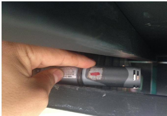
**Figura 55.** Instalación del dispositivo No. 1 adquisición de datos sobre el colector
