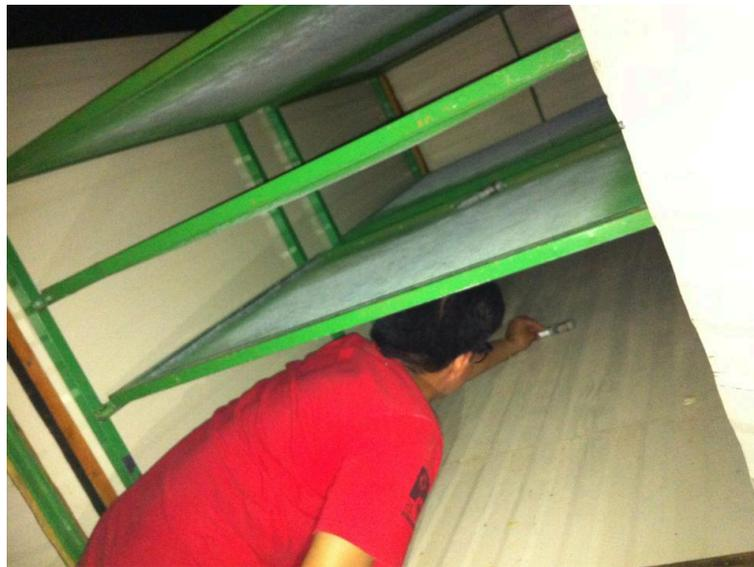
**Figura 59.** Instalación del dispositivo No. 5 adquisición de datos en la parte inferior del secador
