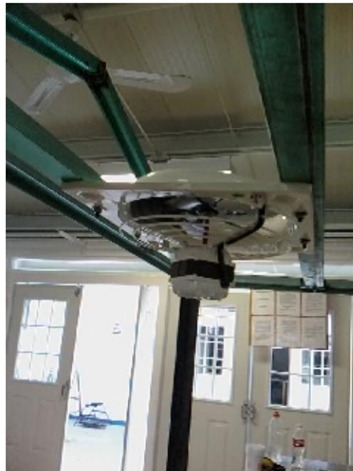
**Figura 27.** Instalación del sistema de flujo forzado del secador solar
