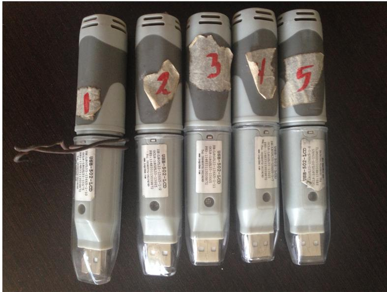
**Figura 54.** Sistemas de adquisición de datos USB-502-LCD numerados
