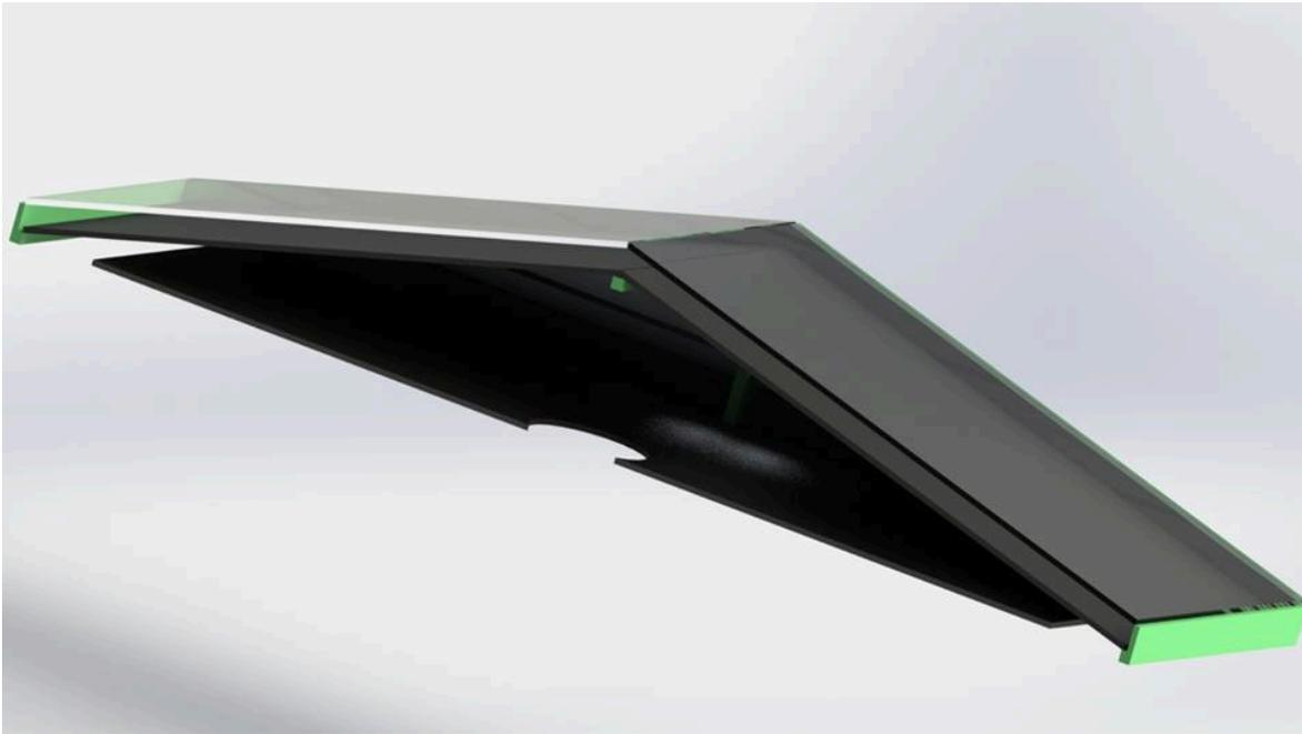
**Figura 23.** Corte transversal del colector solar a dos aguas
