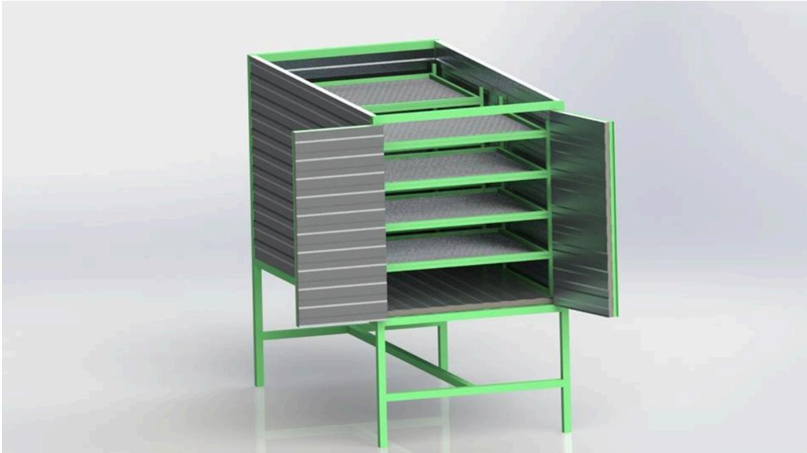
**Figura 20.** Diseño mecánico de la cámara de secado
