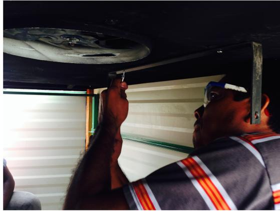
**Figura 45.**Montaje del soporte para el radiador
