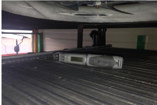
**Figura 56.** Instalación del dispositivo No. 2 adquisición de datos sobre el radiador
