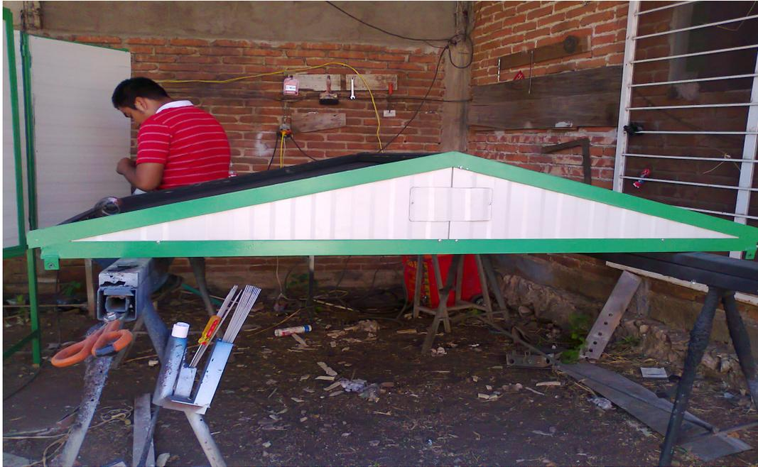
**Figura 26.** Construcción del colector solar
