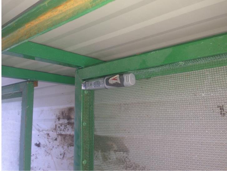
**Figura 58.** Instalación del dispositivo No. 4 adquisición de datos sobre la bandeja intermedia
