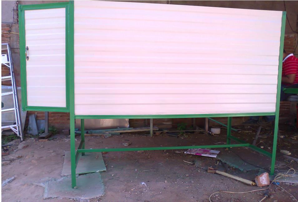
**Figura 28.** Ensamblado del secador solar
