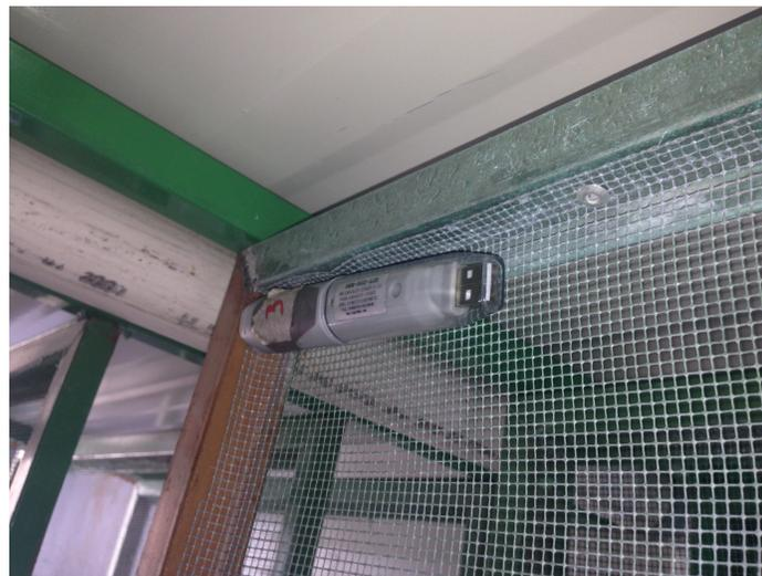
**Figura 57.** Instalación del dispositivo No. 3 adquisición de datos sobre la bandeja más cercana al colector
