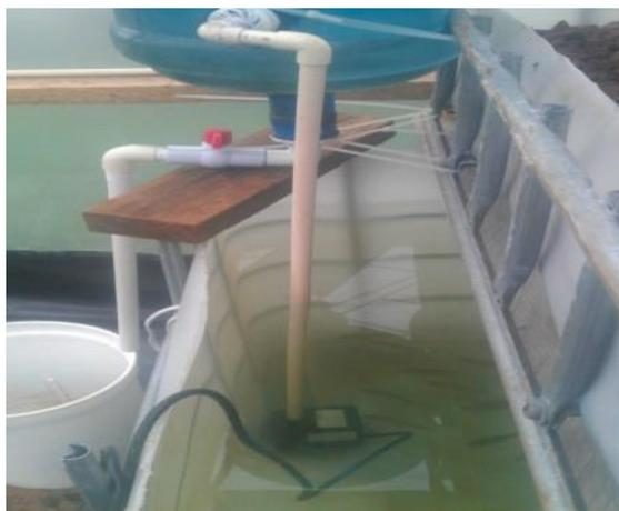
Figura 3. Sistema de recirculación de agua en el sistema acuapónico.
