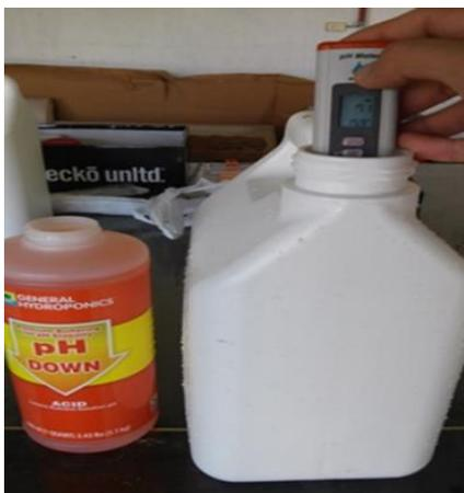
Figura 31. Ajuste de PH en la soluciones nutritivas.
