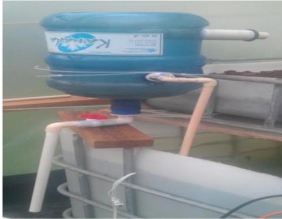
Figura 4. Sedimentador diseñado para la separación de sedimentos sólidos.
