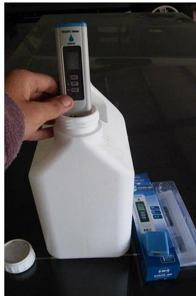
Figura 30. Muestreo de la conductividad eléctrica en las soluciones nutritivas.
