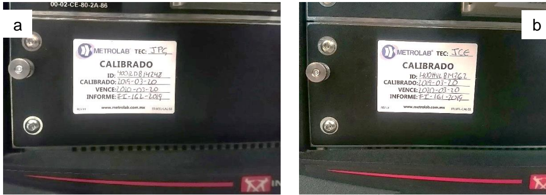
Figura 37. Calibración de las Máquinas. a) Calibración Máquina de prueba a compresión INSTRON modelo 400RD-E1-H2 80 Ton; b) Calibración Máquina de pruebas Universales INSTRON modelo 400HVLB14362-G2A-C3-D28 Cap. 200 Ton.
