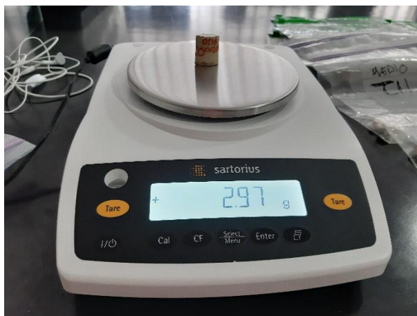
Figura 38. Procedimiento de determinación de peso húmedo de las probetas después de los ensayos mecánicos.
