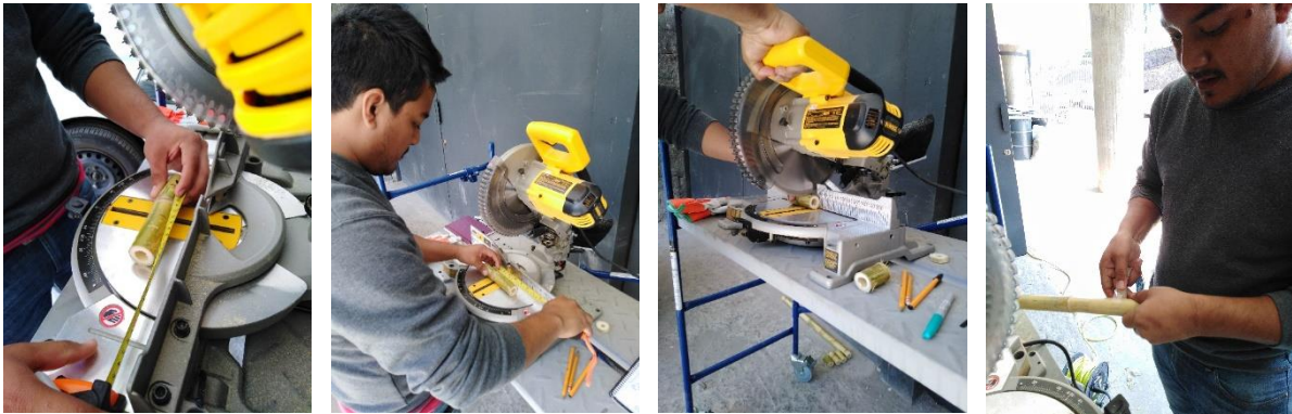
Figura 32. Proceso de corte de las probetas a compresión paralela a la fibra haciendo uso de la sierra ingletadora procurando siempre la paralelidad del corte y mediante el enmascarado con cinta adhesiva en la zona del corte se garantizó un corte preciso sin desprendimiento de fibra.
