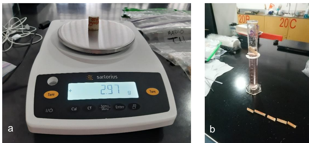
Figura 35. Procedimiento de determinación de peso húmedo y volumen verde de las probetas después de los ensayos mecánicos. a) Peso verde secciones de probetas; b) Determinación del volumen de los especímenes.
