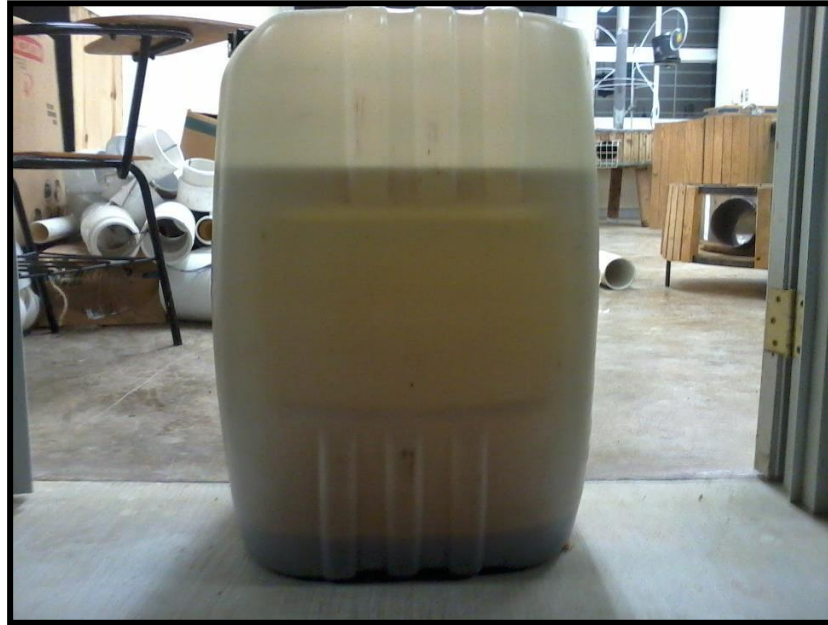
Figura 3.11. Biodiesel y glicerina producido en el reactor solar.
