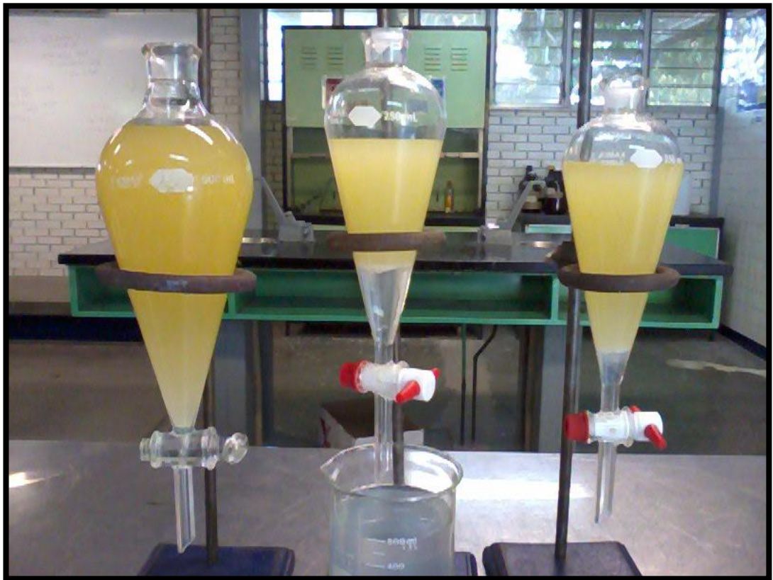
Figura 3.16 Cuarto lavado del biodiesel.
