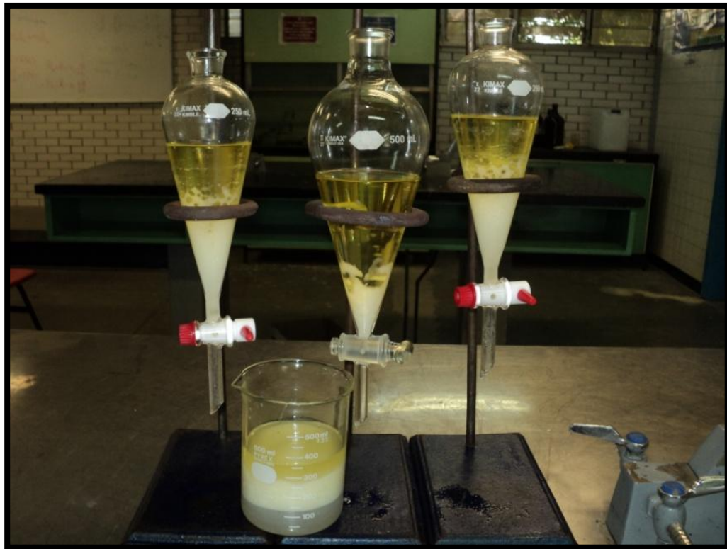
Figura 3.18. Reposo del biodiesel, 15 horas para una óptima separación del biodiesel y de el agua espumosa.
