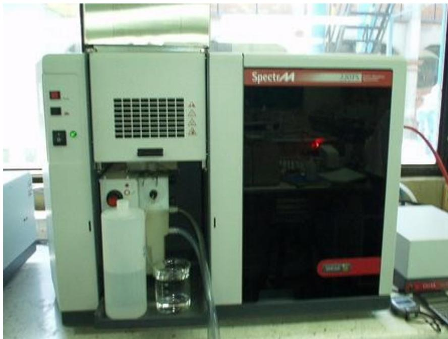
Figura 7 Espectrofotómetro de Absorción Atómica (Modelo Spectra 220FS) ubicado en el Laboratorio de Análisis Instrumental, del Colegio de la Frontera Sur.
