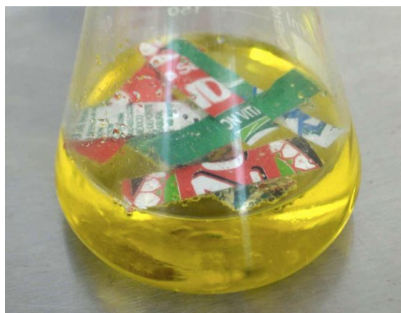
Imagen 12. Tiras de aluminio y ácido muriático
