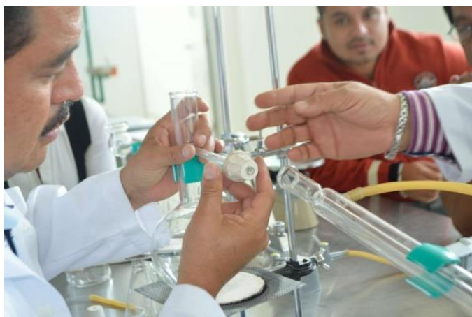
Figura 13. Docentes montando el equipo de destilación por arrastre de vapor
