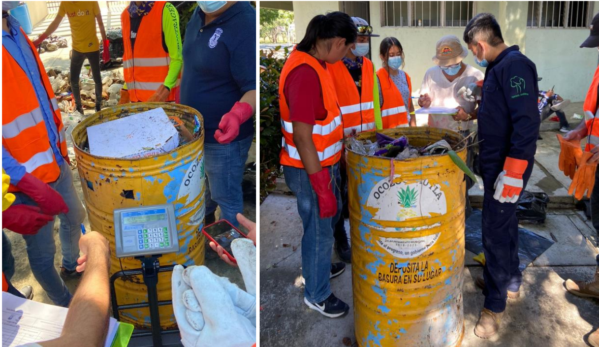
Figura 10. Determinación del peso volumétrico
