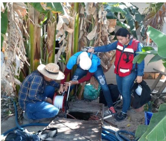
*Fotografía 8a: Obtención del espejo de agua con la sonda de medición (elaboración propia, 2022)*
