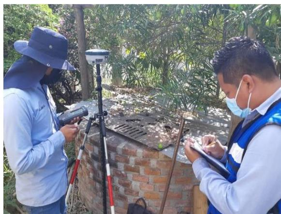
*Fotografía 7b: Obtención de las coordenadas de los pozos con el receptor GNSS, (elaboración propia, 2022)*
