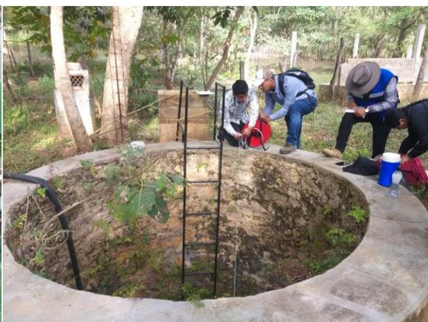
*Fotografía 8b: Obtención del espejo de agua con la sonda de medición, (elaboración propia, 2022)*
