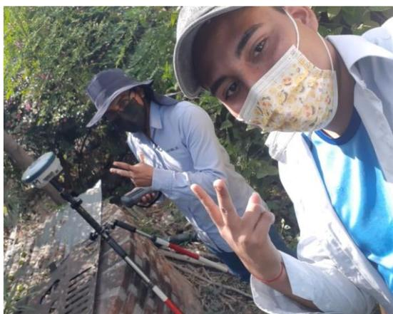
*Fotografía 7a: Obtención de las coordenadas de los pozos con el receptor GNSS, (elaboración propia, 2022)*
