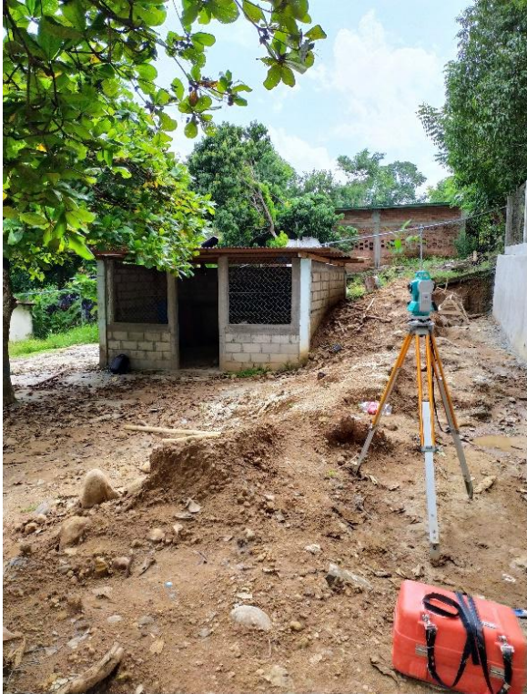
Imagen 1. Nivelación de estación total de instrumento
