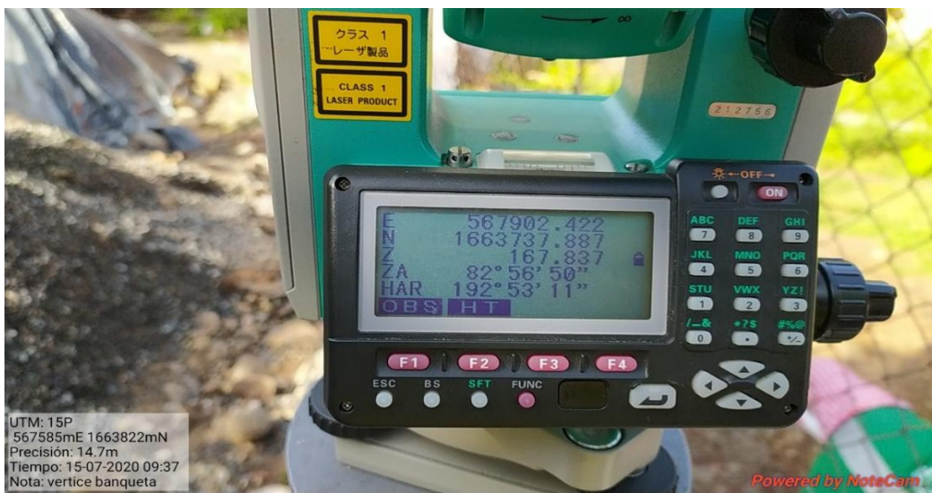
Imagen 4. Coordenadas de punto de control del levantamiento topográfico.
