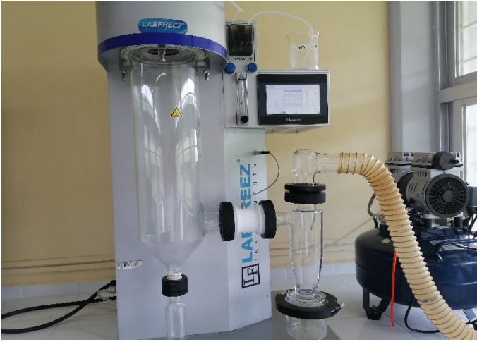
Anexo 7. Proceso de secado del suero de leche por el equipo spray dryer.
