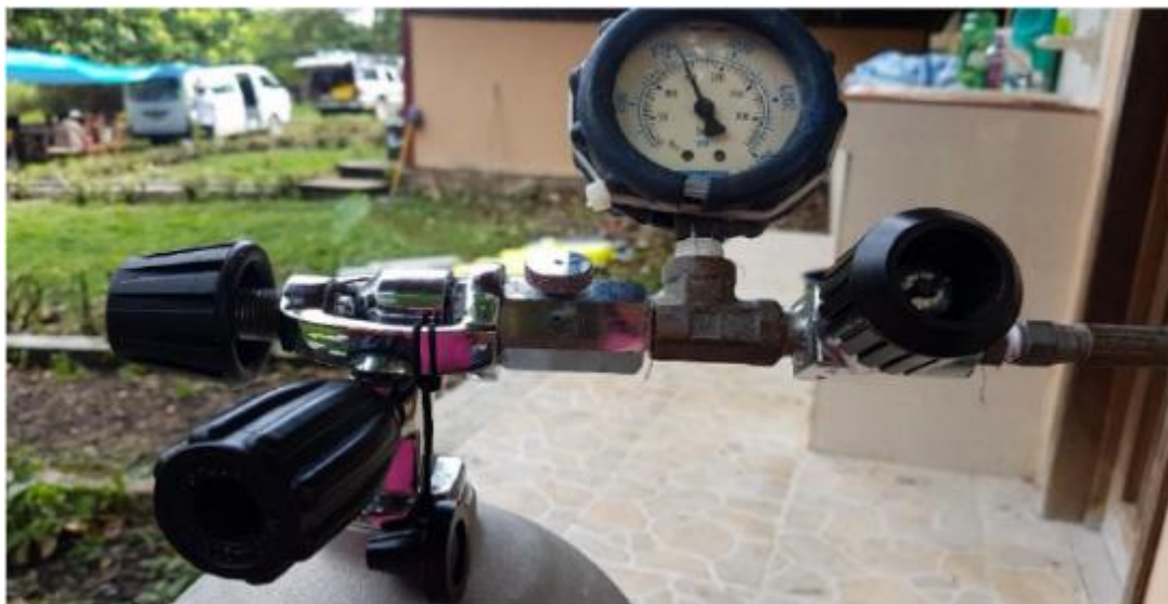
Figura N°12. Tanque conectado al compresor, la válvula marca 2100 PSI (libras sobre pulgada cuadrada), un tanque de aluminio se llena con 3000 PSI. Fotografía tomada por: Noemí Ovando, 2018.
