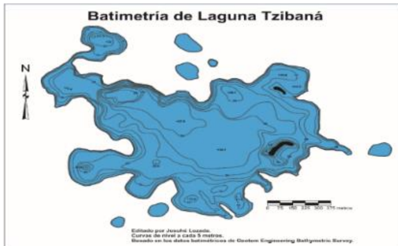
Figura N°34. Mapa batimétrico actual, de laguna Tsibaná. Elaborado por Geotem Engineering Bathymetric Survey y editado por: Josué Lozada, 2022.
