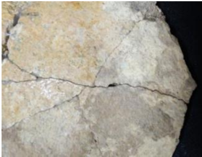
Figura N°439. Vista general que muestra procesos de descalcificación. Fotografía y análisis: Javier Montes, 2021.
