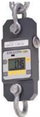
Imagen 2213 Dinamómetro es un dispositivo utilizado para medir la fuerza de compresión.
