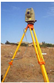
Imagen 20 11 El teodolito es el instrumento de medición mecánico-óptico que la empresa maneja su personal.
