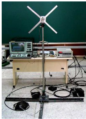
Figura 1.2 Prototipo de aerogenerador para pruebas experimentales.
