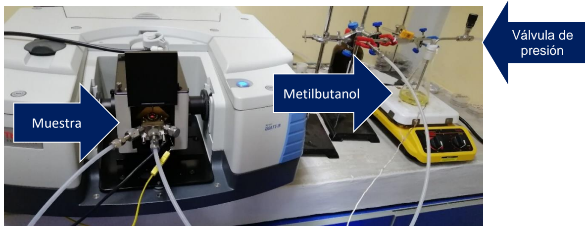
Figura 2.12. Estudio de basicidad utilizando el equipo de caracterización FT-IR modelo iS50.
