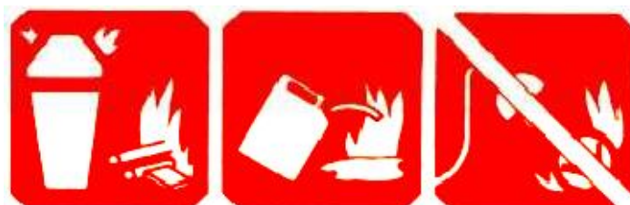
Figura 6. Usar solo extintores para fuego clase "A".
