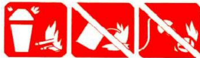
Figura 7. Usar solo extintores para fuego clase "A" y "B".
