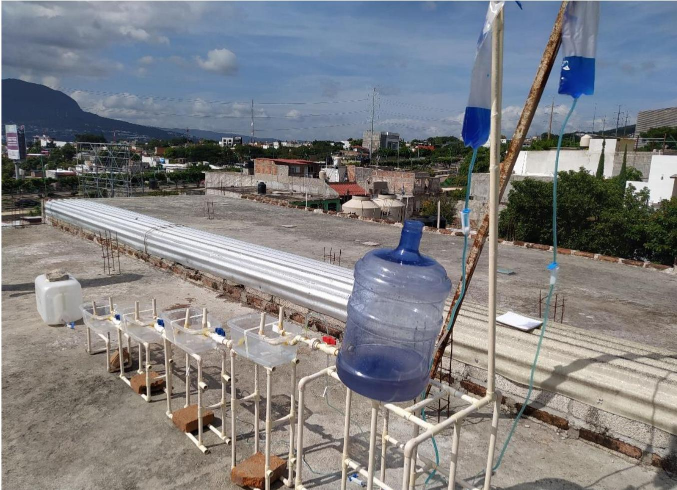
Fig. 41. Primer tratamiento utilizando como agente sensibilizador el azul de metileno.
