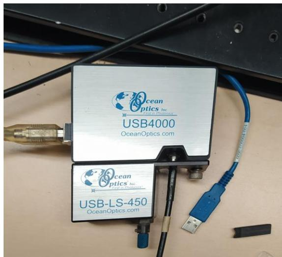
**Fig. 24. Espectrómetro de fibra óptica Ocean Optics USB4000.**
