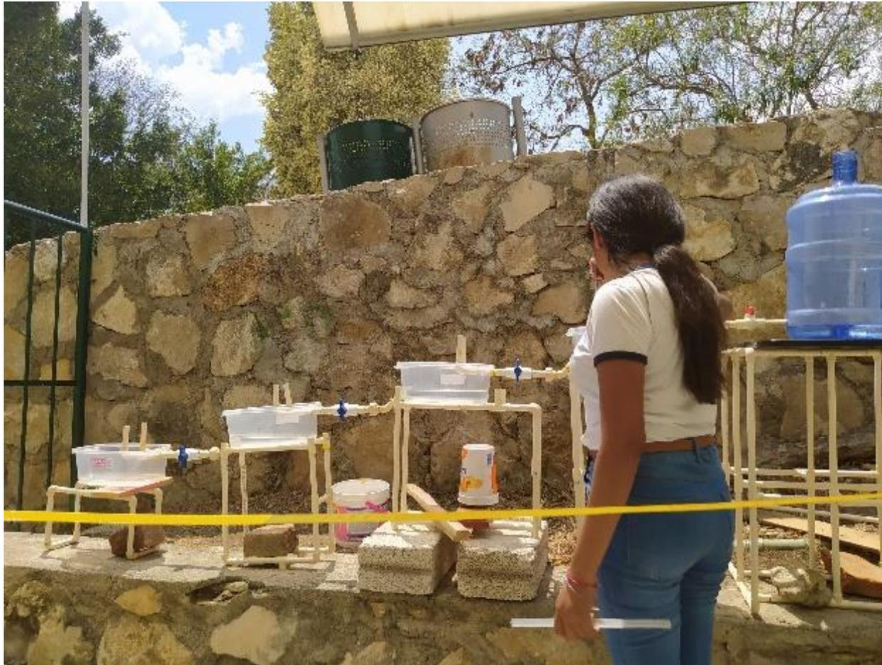
Fig. 33. Evaluación de las variables (temperatura, volumen, tiempo) del tren de tratamiento.
