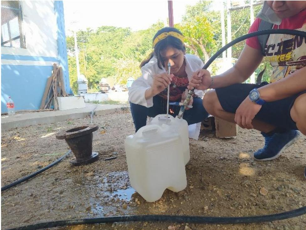
**Fig. 38. Colecta y toma de temperatura del agua de la Planta de Bombeo Culati, Chiapa de Corzo.**
