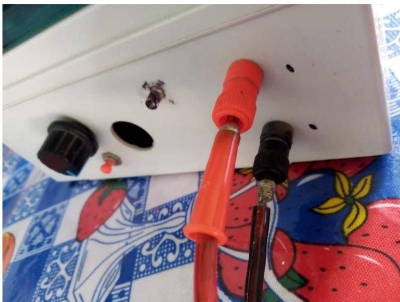
*Figura 28. Cable usado para interconectar módulo a dispositivo graficador, por un extremo se acoplaron conectores mc4 y por el otro conectores tipo bananas.*
