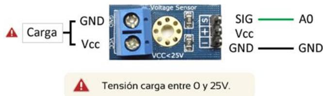
*Figura 21. Conexiones de entrada y salida del sensor (Luis, Sin Dato).*
