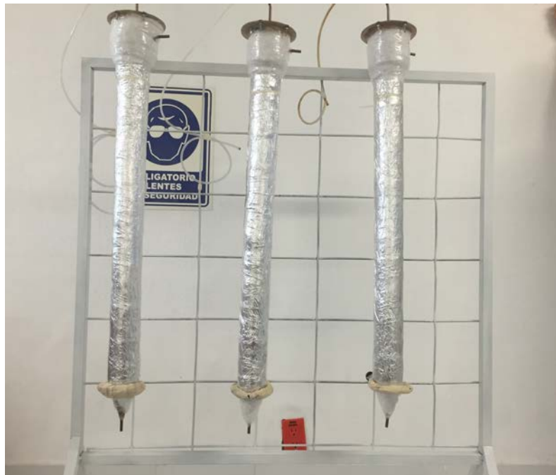
Figura A4 Montaje de los biorreactores EGSB
