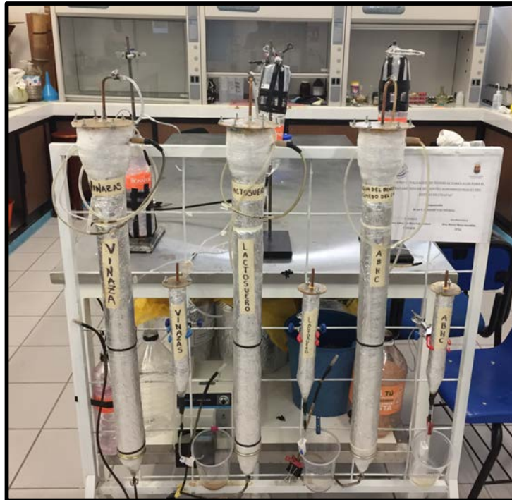
Figura 5.17 Biorreactores EGSB en operación
