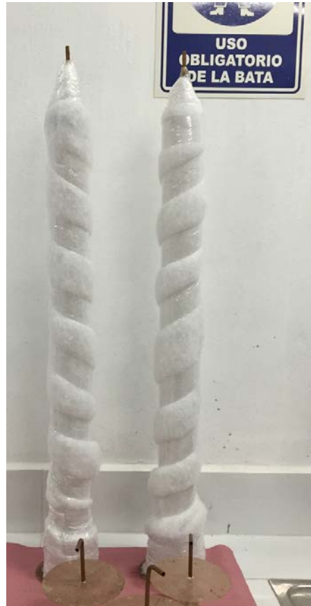
Figura A3 Asilamiento térmico del biorreactor EGSB
