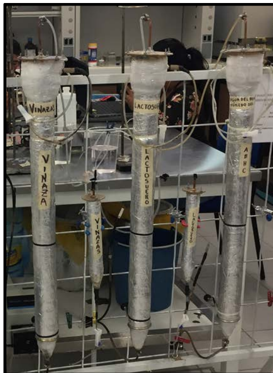
Figura 4.7 Arranque de los biorreactores EGSB
