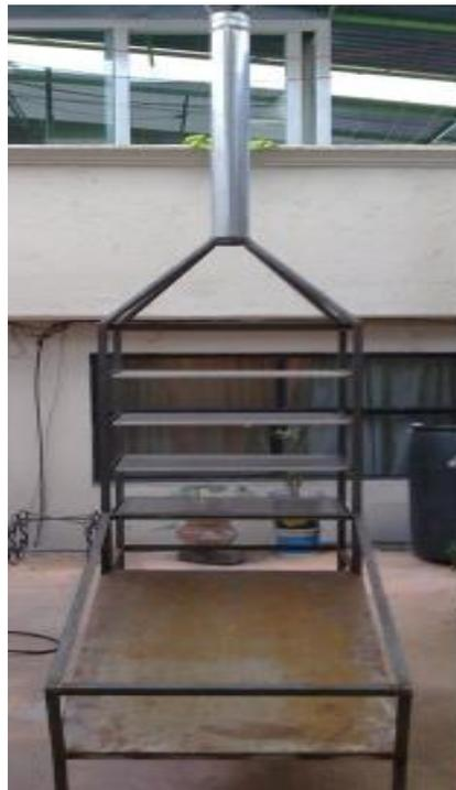
Figura 1.2 Estructura del secador solar.
