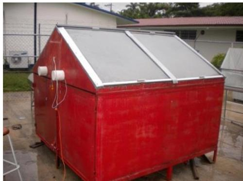
Figura 2.16 Secador indirecto con circulación forzada.
