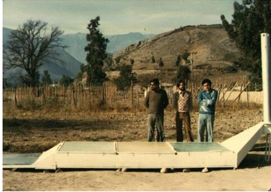
Figura 2.17 Secador Solar Mixto.
