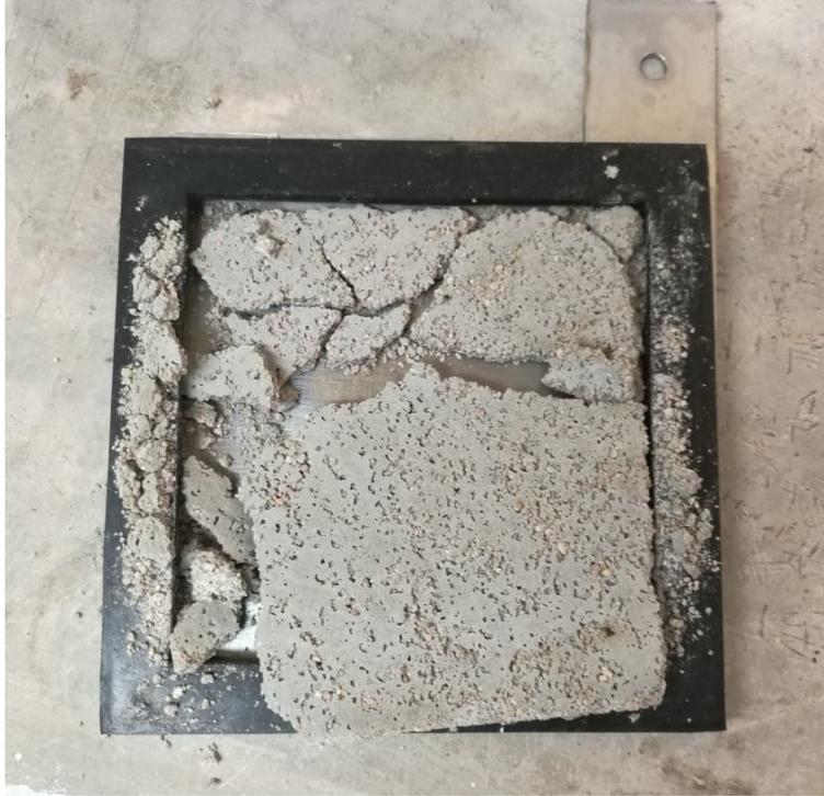
Figura 5.15: Mezcla 20 % cemento 80 % arena.
