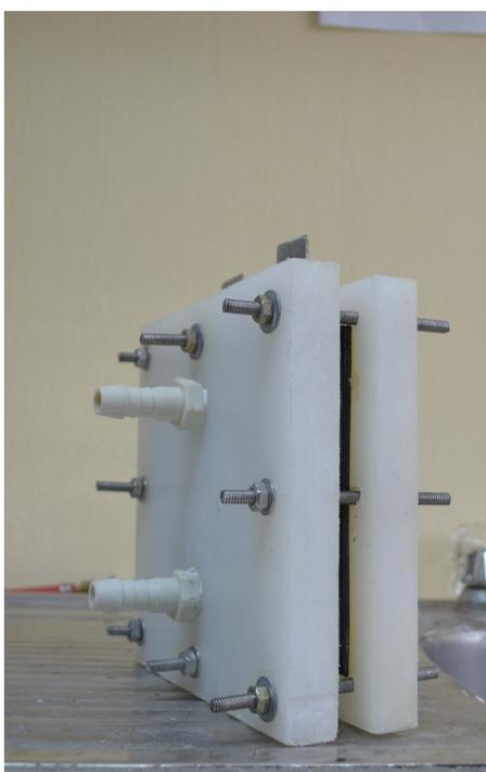
Figura 5.13: Ensamble final del electrolizador.
