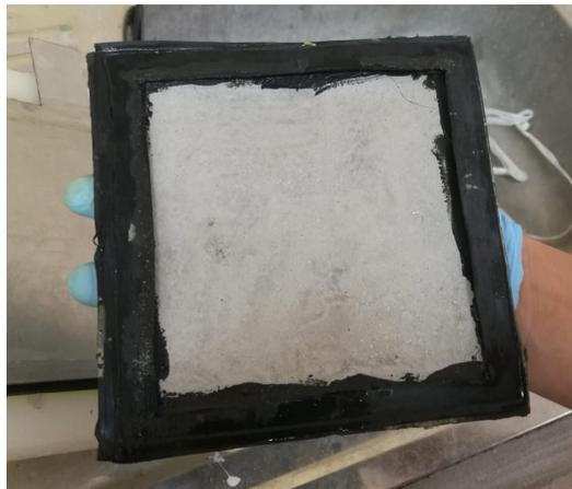
Figura 5.18: Mezcla 60 % cemento 40 % piedra volcánica.
