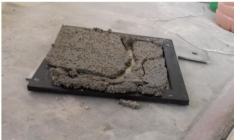
Figura 5.12: Mezcla 10 % de cemento y 90 % arena.
