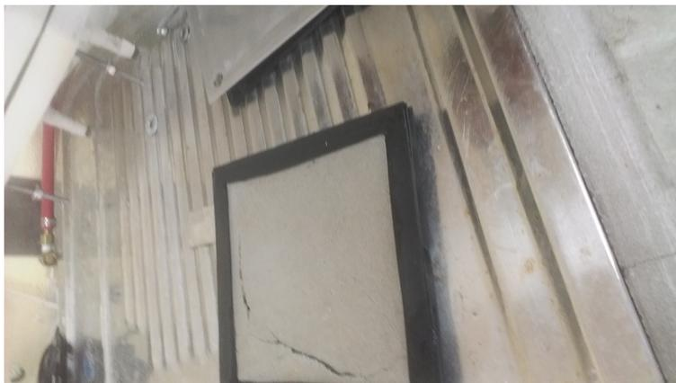
Figura 5.16: Mezcla 20 % cemento 80 % piedra volcánica.
