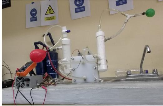
Figura 5.22: El globo de color rojo contiene Hidrógeno y el globo de color verde contiene oxígeno.
