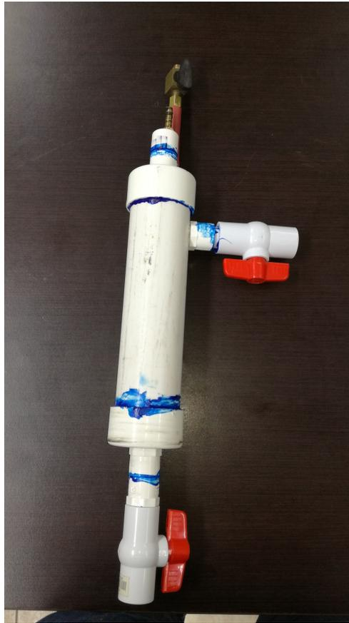
Figura 4.17: Filtro de purificación con componentes conectados.
