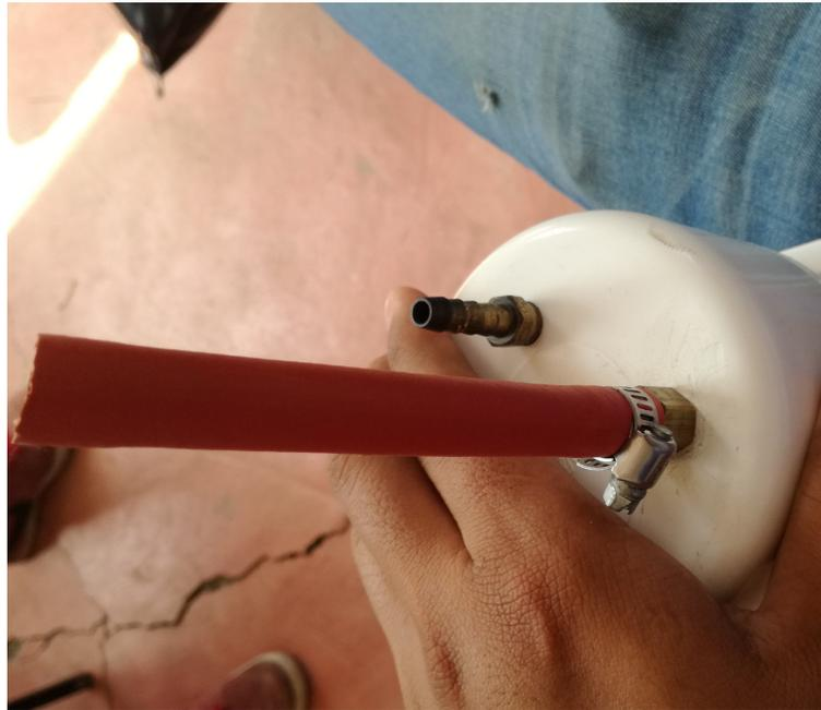
Figura 4.15: Adecuación de válvulas conectoras a la tapa de entrada.
