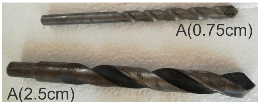
Figura 4.10: Brocas utilizadas para las perforaciones.
