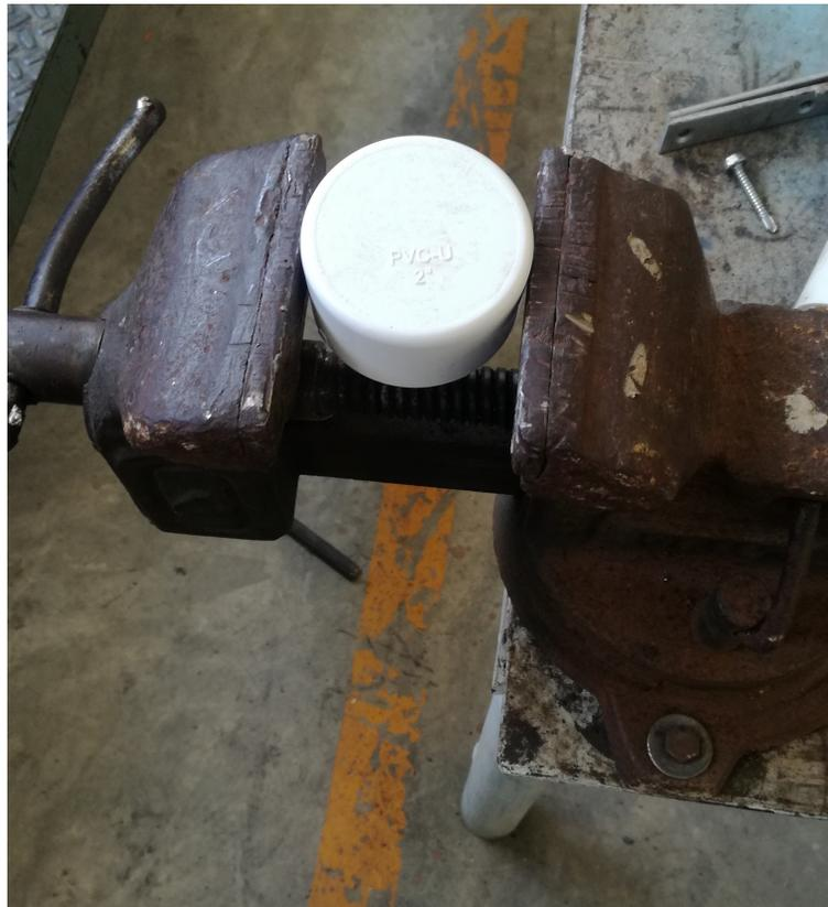
Figura 4.11: Colocación de tapas sobre prensa de banco previo a su perforación.
