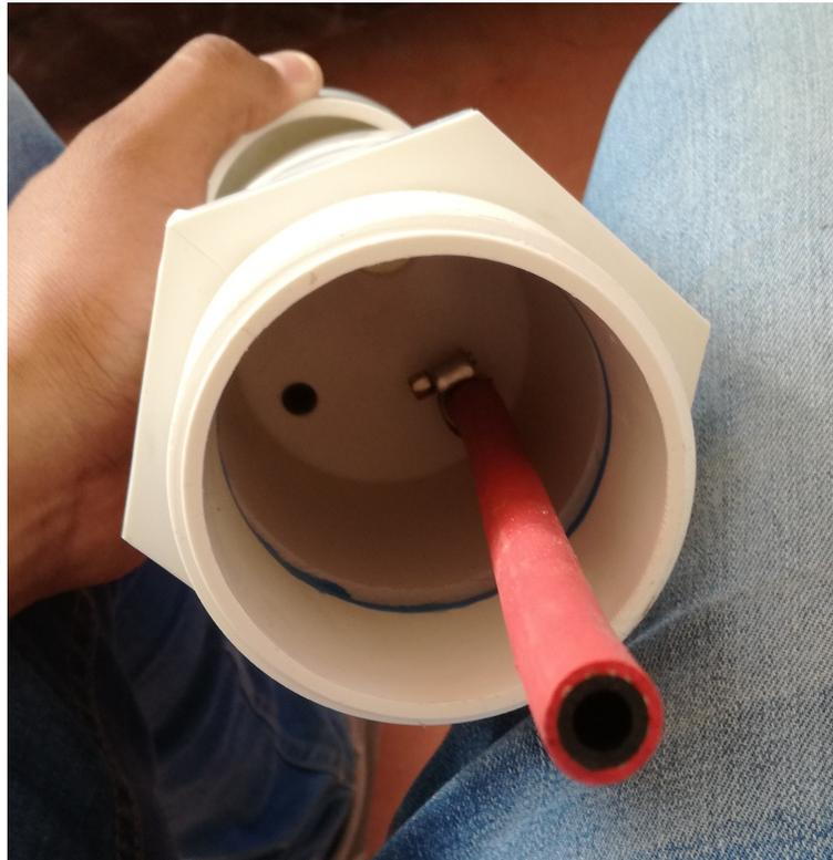
Figura 4.16: Adecuación interna del sistema conductor de biogás.
