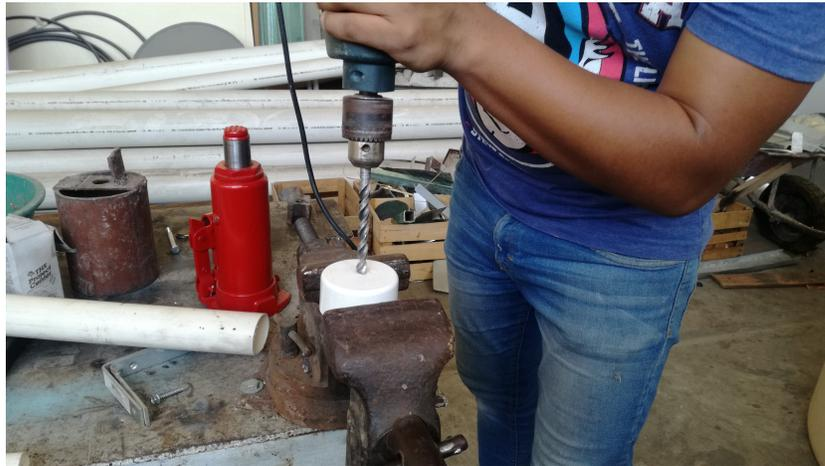
Figura 4.12: Perforación a las tapas.
