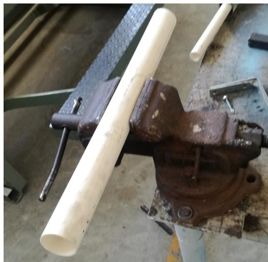
Figura 4.9: Tubería PVC adecuada a longitud de 25 cm.
