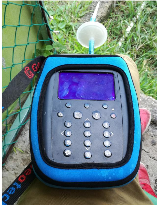
Figura 4.21: Equipo Landtec GEM-5000 utilizado para los análisis de biogás.
