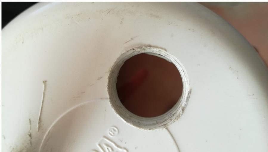
Figura 4.13: Perforaciones realizadas a las tapas (superior e inferior)
