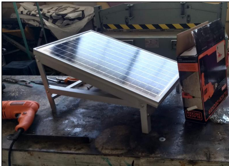
Figura 4.1 Módulo fotovoltaico con estructura.
