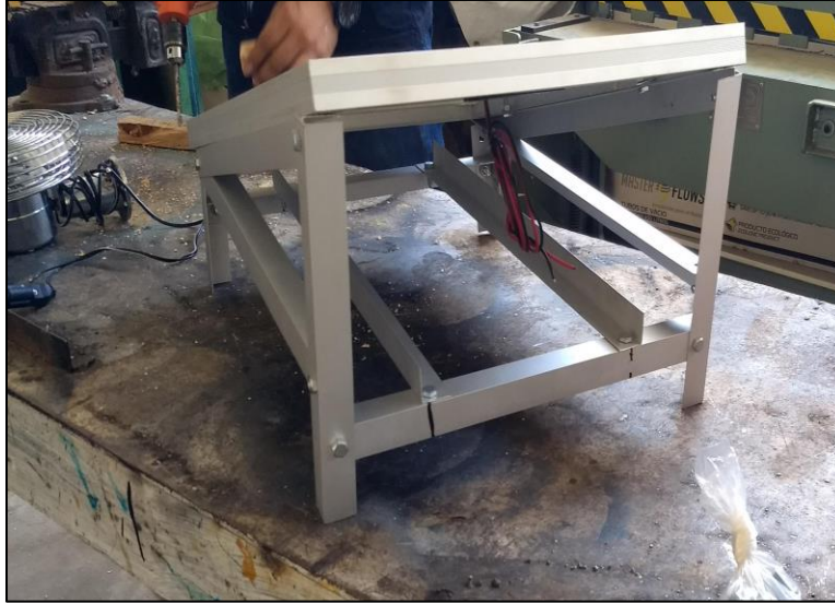
Figura 4.2 Parte posterior del módulo fotovoltaico con estructura.
