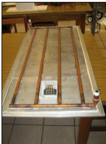
Figura 1.4 Tubería de la parte posterior del módulo solar.
