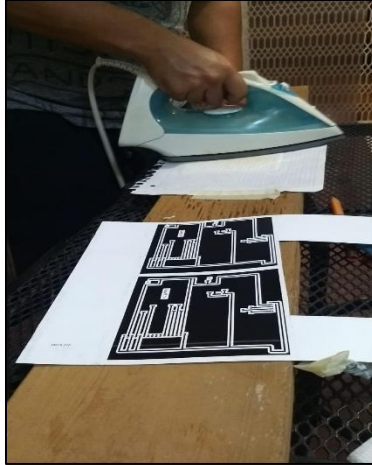
Figura 3.33 Método del planchado.
