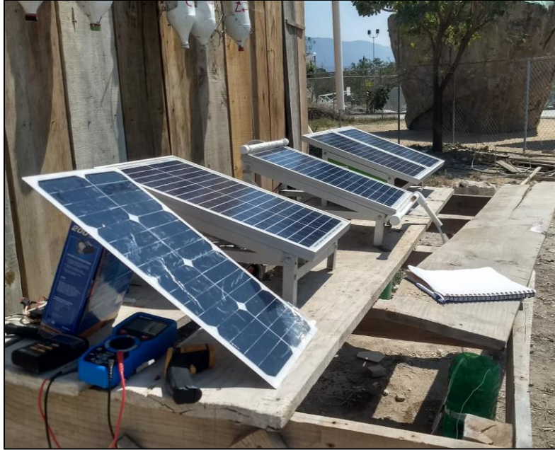
Figura 4.3 Evaluaciones de los diferentes módulos fotovoltaicos.
