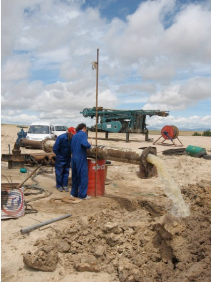
Figura 13. Aforador y en la medición de caudales. Fuente: Gancio, (2015).
