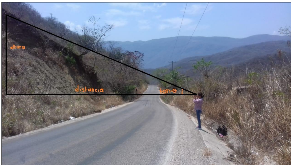
Figura No. 34.- Medición de la altura del talud; (Fuente: Propia, trabajo de campo,10/02/2019)
