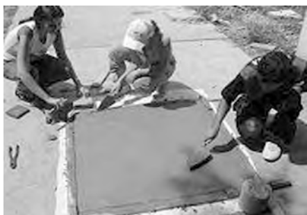
Figuras 6. Parte del proceso de fabricación de una pieza de componente para techo Domotej , elaborado en instalaciones de la Facultad de Arquitectura de la Universidad Autónoma de Chiapas, México, en Tuxtla Gutiérrez, Chiapas.
