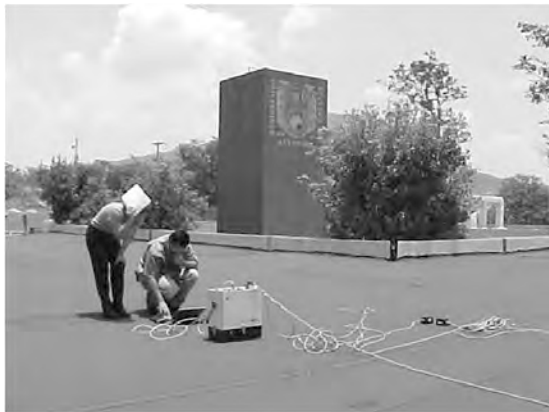
Figura 10. Registro de la vibración ambiental en la azotea del edificio reforzado.
