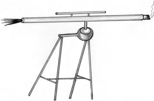
Con la idea fija del cañoncito en mi mente, decidí fabricar el mío con tecnología propia. Conseguí una terminal de dirección usada de automóvil, de las que cambiaban en el taller, y pedí que le pusieran patas de alambrón y que le soldaran un tubo galvanizado de media pulgada en la parte
