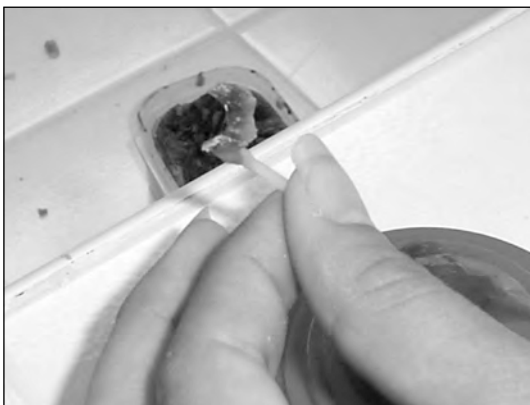
Se coloca un cuele al encerado (éste debe quedar con un ángulo de 45° para facilitar la entrada del metal fundido), después se coloca el encerado con el cuele en la peana para colocar el cubilete (figuras 129 y 130).
