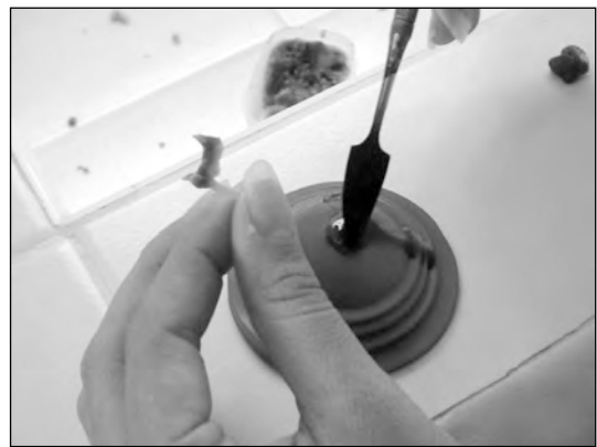
Se coloca un cuele al encerado (éste debe quedar con un ángulo de 45° para facilitar la entrada del metal fundido), después se coloca el encerado con el cuele en la peana para colocar el cubilete (figuras 129 y 130).
