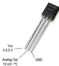
Figura 23: Sensor de temperatura LM35.
