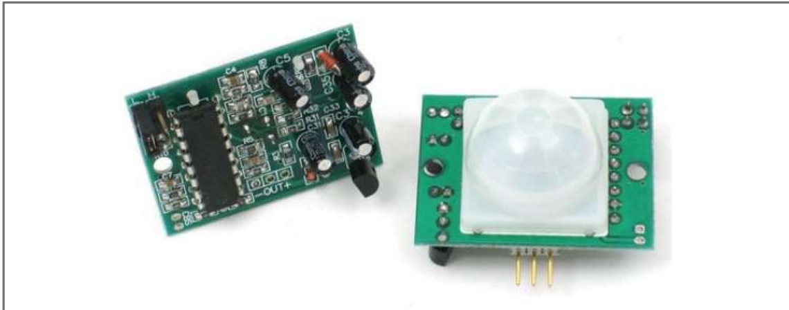
Imagen 2.5 Sensor PIR Esta es la apariencia de un sensor PIR utilizado en el proyecto de automatización del 3IER.
