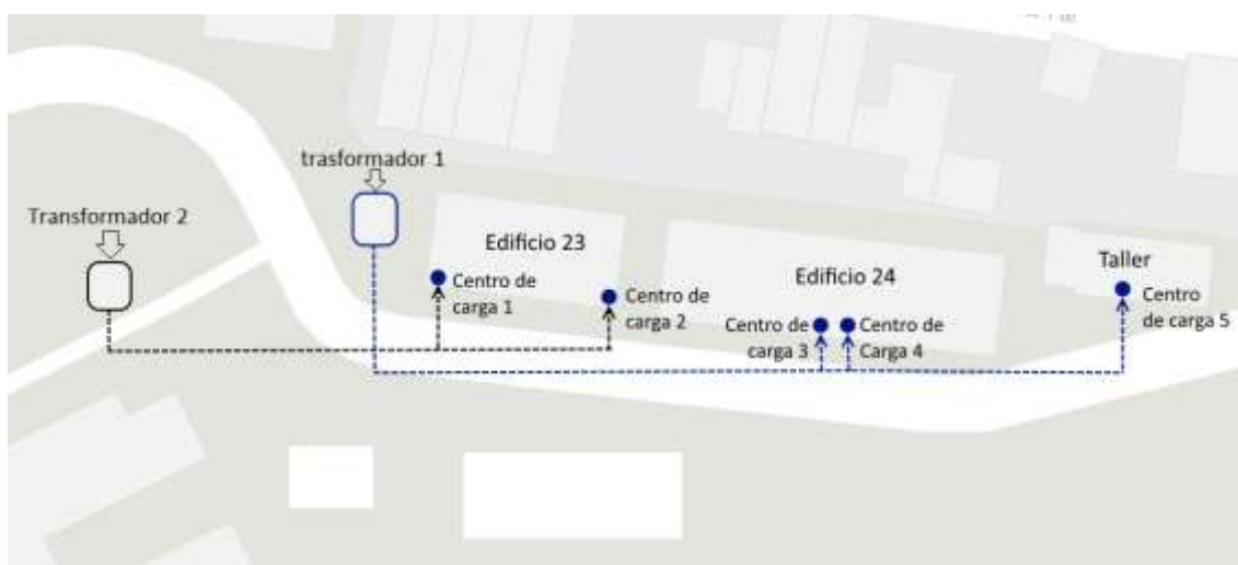
Imagen 4.2.6 Conexión de circuitos de alimentación Los circuitos eléctricos 1 y 2 se conectan a los centros de carga 1 y 2, los cuales son la fuente de alimentación del edificio 23. Los circuitos 3, 4 y 5 suministran energía eléctrica al edificio 24 y al taller. El total de los centros de carga recibe potencia de dos transformadores, tal y como se muestra en esta imagen.
