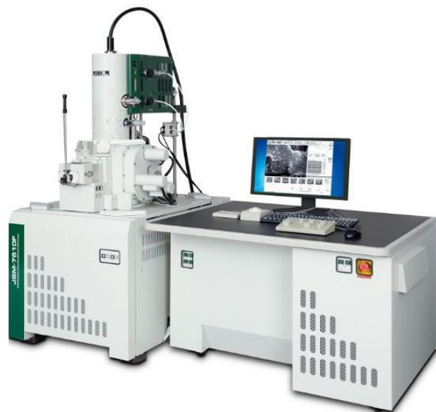
*Figura 35. Equipo de Microscopia electrónica de barrido.*
