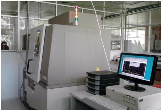
*Figura 34. Equipo de difracción de Rayos X Rigaku modelo DMAX 2000.*
