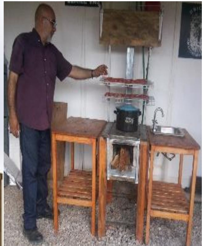
Fig. 5.12 Estufa ecológica multifuncional leña-biogás con aditamentos para aprovechamiento integral de la energía.
