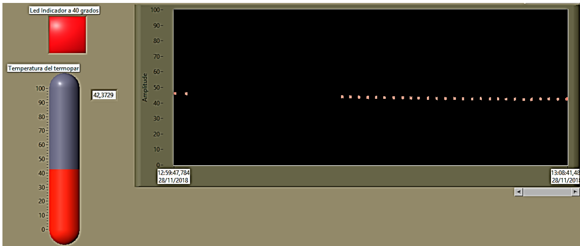
Figura 8. Gráfica de Termopar en tiempo real corriendo con cámara termográfica
