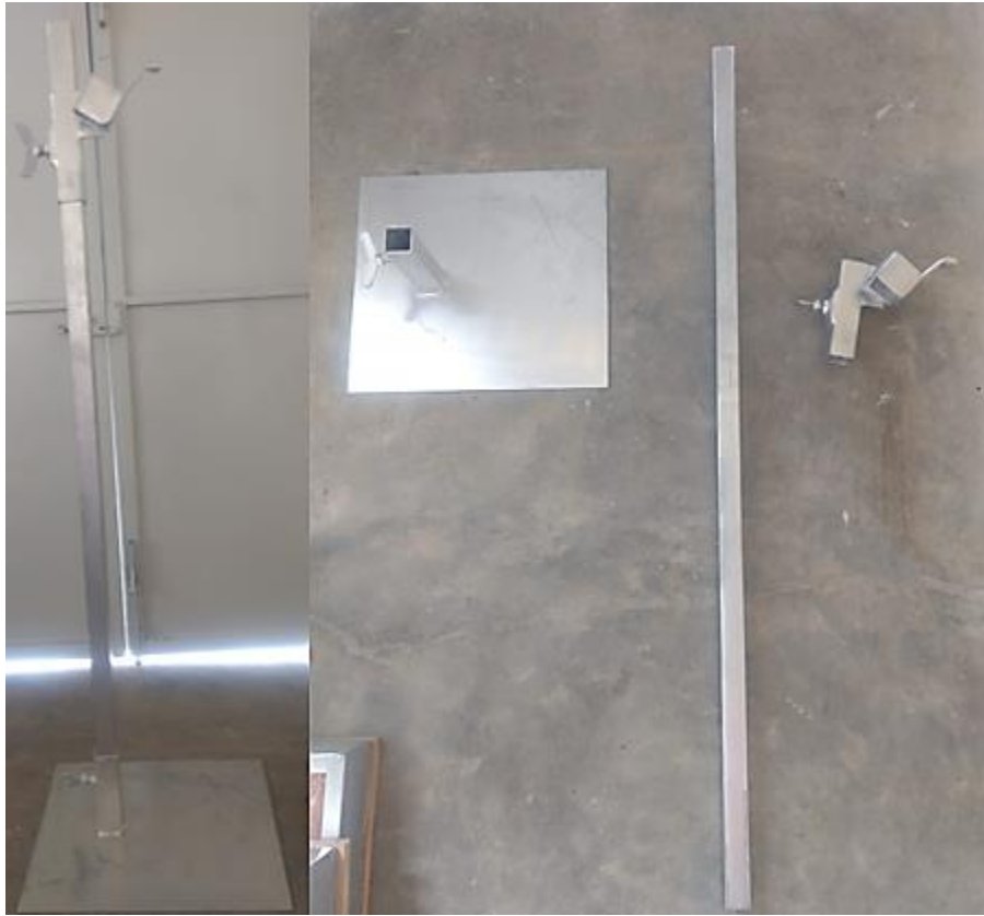
Figura 5. Soporte modular para cámara termográfica FLIR E60
