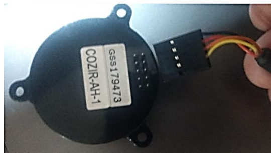
Figura 11. Conexión del Sensor de CO 2
