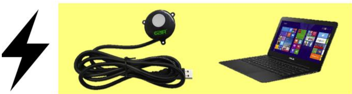
Figura 3.8 – Energización del Sensor de CO 2
