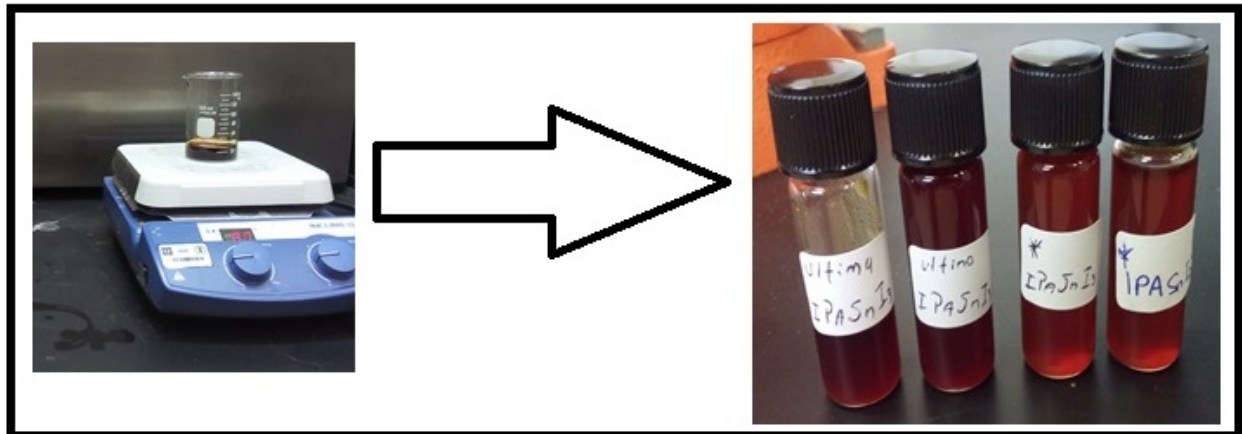
Figura 2.14: Síntesis de IPA-SnI 3 por deposición directa.
