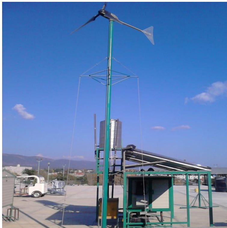
Figura A4. Imagen de la Vista lateral izquierda del sistema híbrido termosolar eólico.
