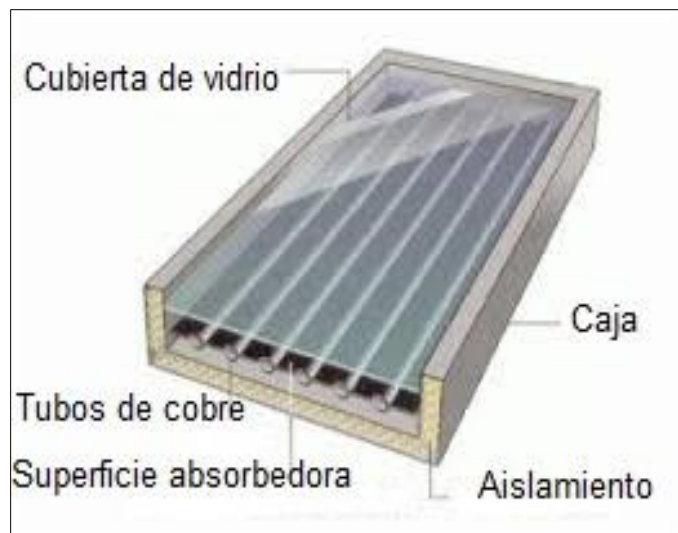
Figura 2.10. Esquema de un colector de placa plana con cubierta [18].
