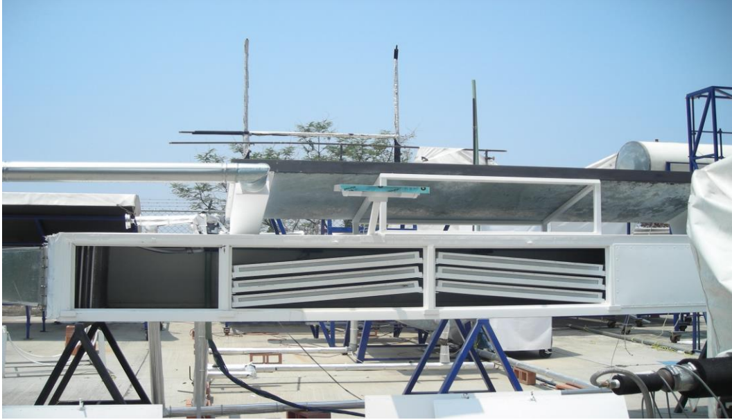
Figura 1.3. Deshidratador Solar Combinado Térmico-Fotovoltaico, Vista frontal del túnel de secado, (Gama, 2007).
