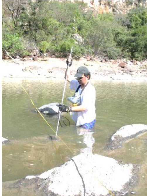
Figura 3.2 Medición de gastos en corrientes naturales [R.16]
