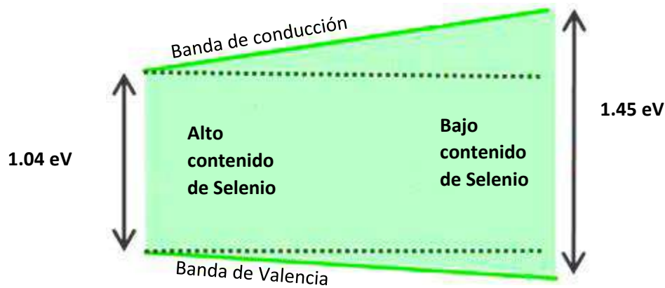
Figura 2.5. Los cambios en el borde de la banda de conducción y de valencia, como propone Woo et al. [47].
