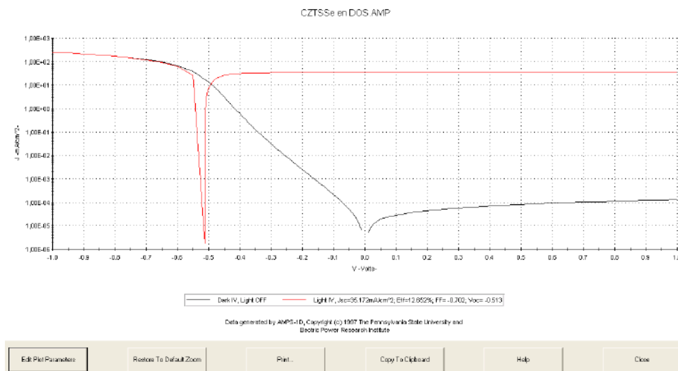
Figura A12. Graficos en AMPS-1D, se muestra las curvas J-V en oscuridad y bajo iluminacion de la simulacion de la celda solar de CZTSSe.
