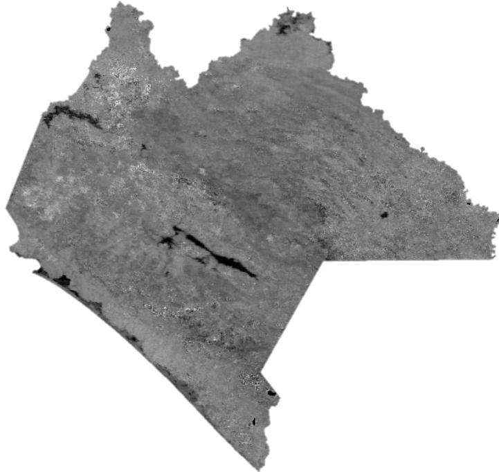
Figura 22: Mapa de albedo interpolado espacialmente con GRASS GIS del día juliano 161. Mapa final de albedo para generación de datos de radiación solar en condiciones de cielo despejado.
