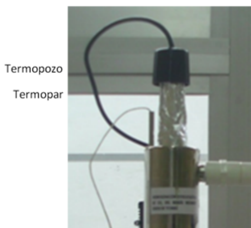
Figura 3.14: Termopar insertado en termopozo.
