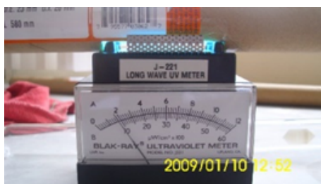
Figura 3.13: BLAK-RAY mod J-221. Medición de intensidad.
