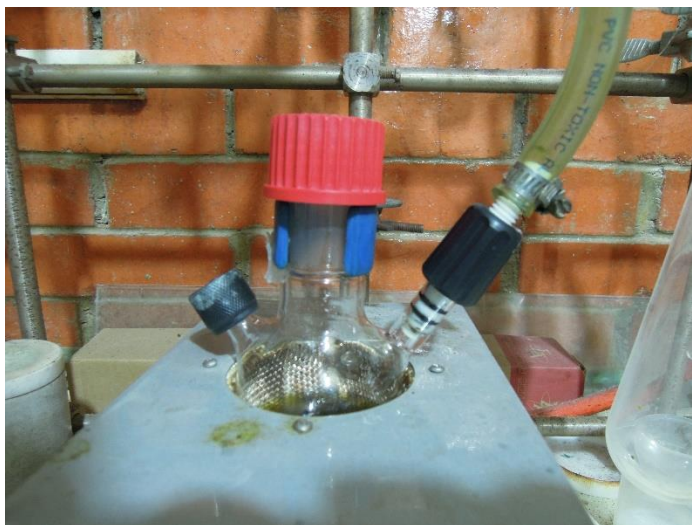
Figura 3.5. Matraz sujeto al sistema Schlenk para proceso de síntesis.
