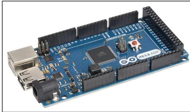
*Figura 1.3. Placa de Arduino Mega ADK [41].*
