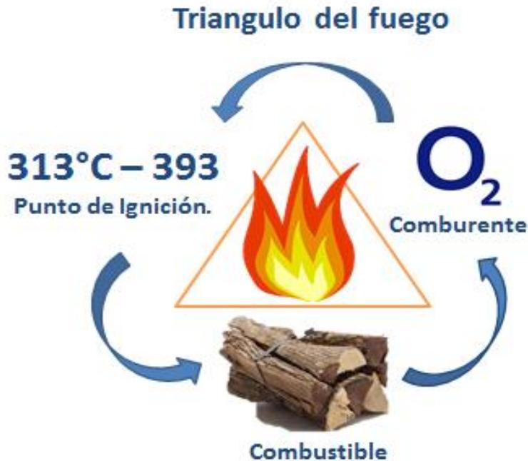
**Figura 2: Triángulo de fuego.**
