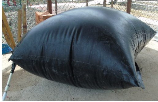
Figura 4.4: Bolsa de geomembrana llena de aire.
