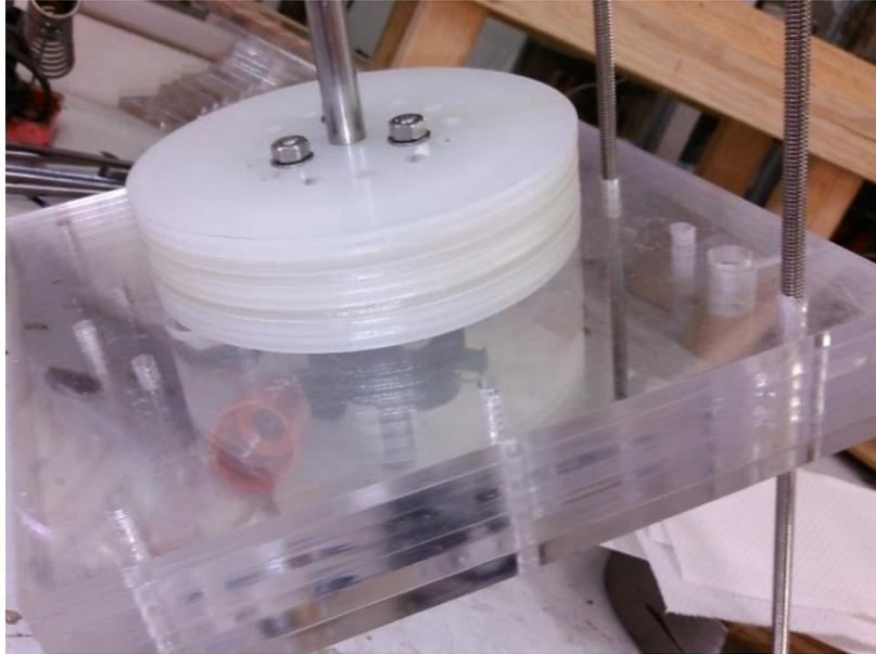
*Ilustración 5-9. Ensamble de las primeras 3 etapas y un conjunto de 10 discos.*
