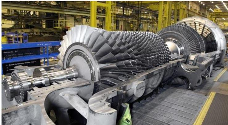
Ilustración 1-5. Turbina de gas moderna[3].
