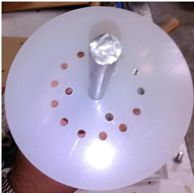
*Ilustración 5-8. Ensamble de disco costado a laser.*
