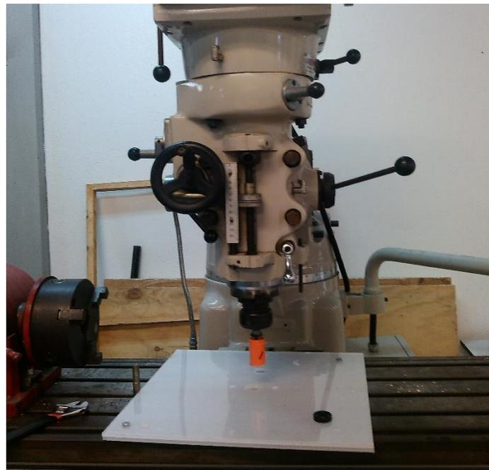
*Ilustración 5-16. Maquinando agujeros para sujetadores del eje.*
