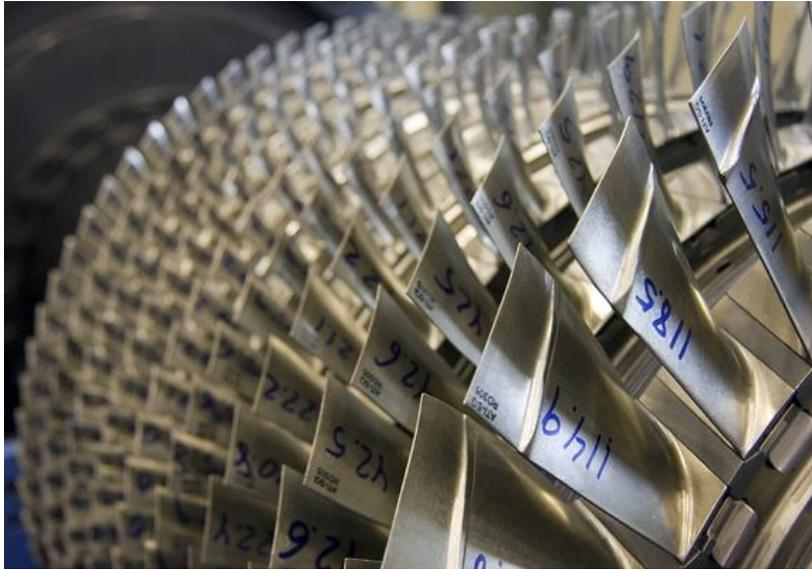
*Ilustración 1-7. Álabes de una turbina de reacción.*
