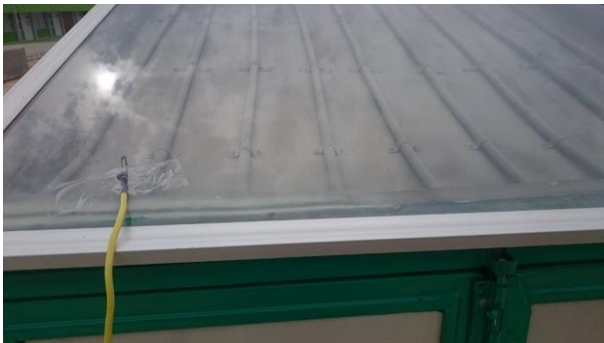
Figura A3 Termopar en la placa de cristal
