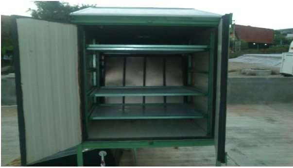
Figura A1 Vista interior del secador solar indirecto
