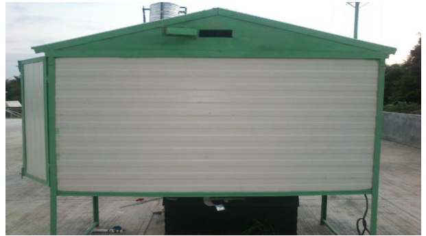
Figura A2 Vista lateral del secador solar indirecto
