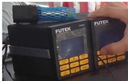
Fig. 5.5.- Medidor Futek y sensor de presión (Medina, 2014).
