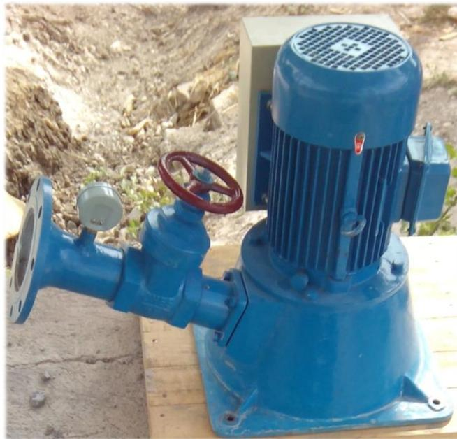
*Fig. 3.25.- Sistema micro hidroeléctrico Turgo (Medina, Fotografía, 2014).*
