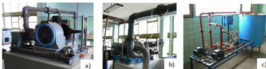
Fig. 1.5.- Banco de ensayos: a) Turbina Peltón, b) Turbina Francis, c) Bombas axiales (Depto. de Hidráulica, 2009).
