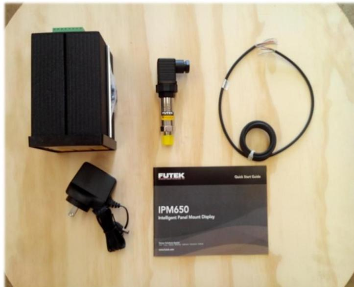
Fig. 3.28. Panel Inteligente de Montaje y sensor de presión. (Medina, Fotografía, 2014)
