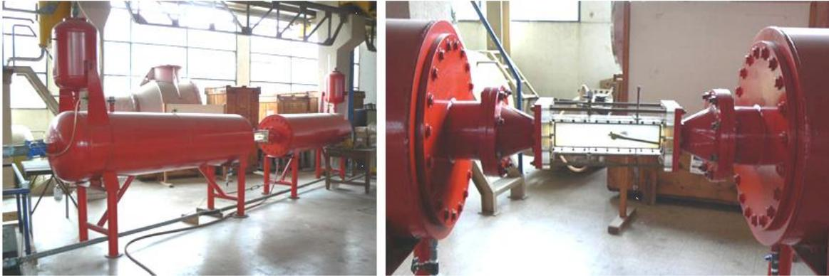
Fig. 1.6.- Circuito de Cavitación (Depto. de Hidráulica, 2009)
