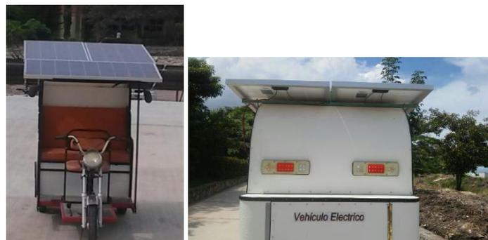
**Figura 3.2.** Vehículo con módulos fotovoltaicos instalados
