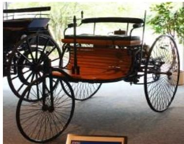
**Figura 1.2.**Automóvil de Karl Benz, primer coche de combustión interna (9).
