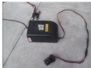
**Figura 4.8.** Cargador de alimentación 220 volts y salida a 48 Vcd
