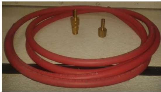
Figura 30. Manguera y conexiones para flujo de gas.
