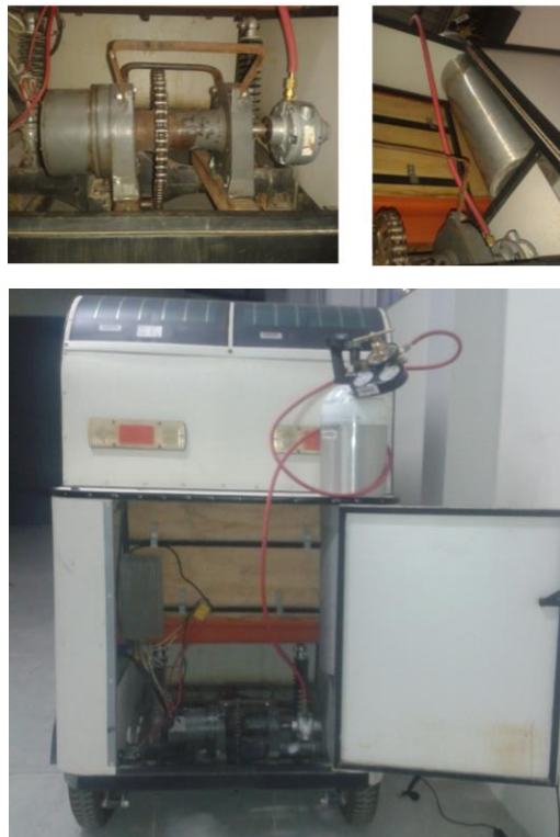
Figura 43. Vehículo a base de aire comprimido.
