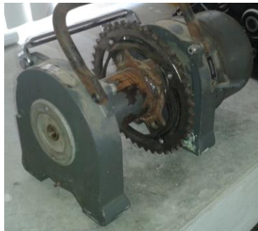
Figura 41. Corona soldada al sistema de engranes.
