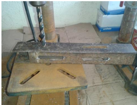
Figura 35. Perforaciones en la base de hierro para sistema de engranes.
