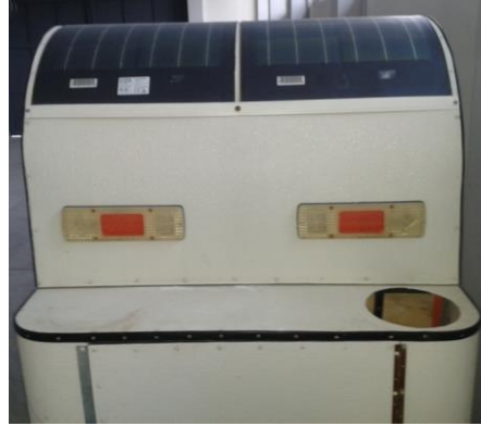
Figura 33. Corte circular para inserción del tanque de aire.
