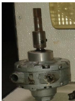
Figura 38. Pieza torneada para conexión entre engranes y motor neumático.
