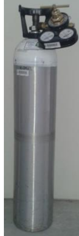
Figura 23. Tanque de duraluminio con regulador de presión.
