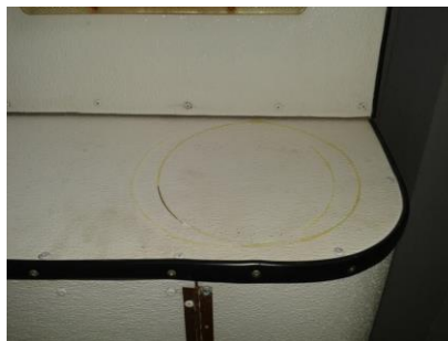
Figura 32. Círculo guía para realizar corte para insertar tanque.
