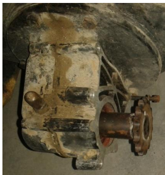
Figura 40. Piñón soldado al conector del diferencial del ecotaxi.
