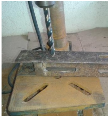
Figura 31. Taladro de banco y broca.
