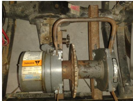
Figura 37. Sistema de engranes acoplado en el ecotaxi.
