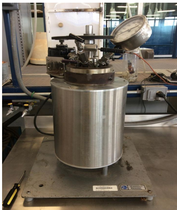
Figura 3.3 Reactor a presión
