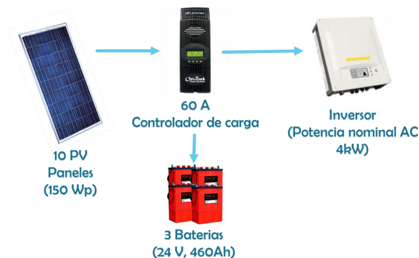
Figura 4.27 Sistema fotovoltaico autónomo
