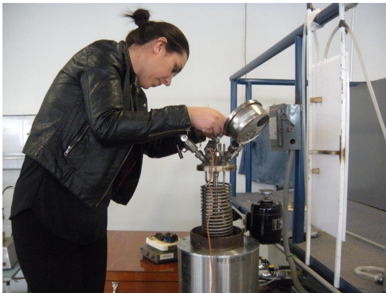
Figura 4.16 Serpentin y chaqueta de calentamiento del reactor a presión
