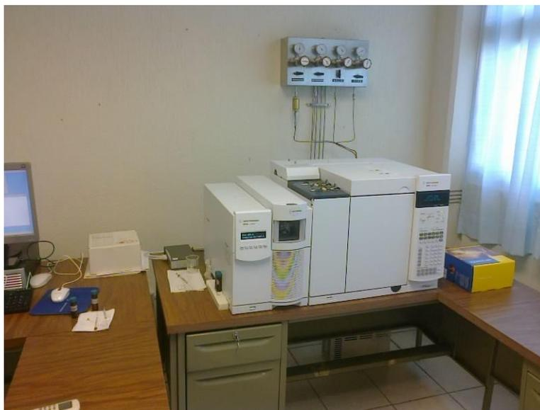
Figura 12. Cromatógrafo de gases y espectrómetro de masas Agilent Technologies (Instituto Tecnológico de Tuxtla Gutiérrez).
