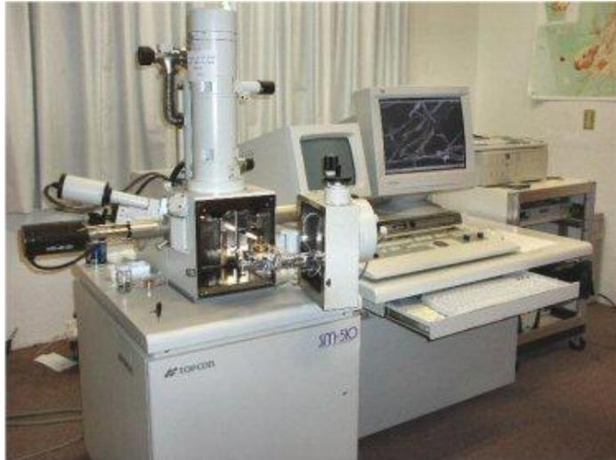
Figura 11. Microscopio electrónico de barrido TOPCON SM-510 (Colegio de la Frontera Sur, Unidad Tapachula).
