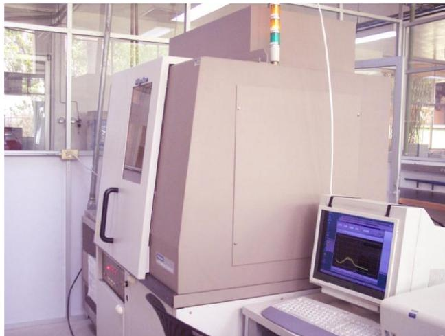
Figura 10. Difractómetro de rayos X modelo DMAX 2200. (IER, UNAM).
